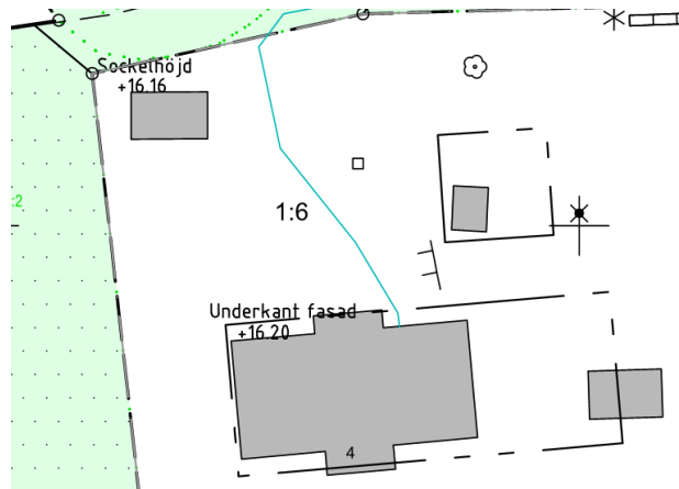
Sockelhöjd och underkant fasad. Fastigheten Bullsta 1:6
